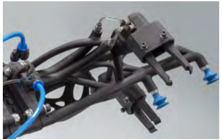
Figuur 26: Een robot gripper ontworpen mbv topology optimisation (bron Philips)
