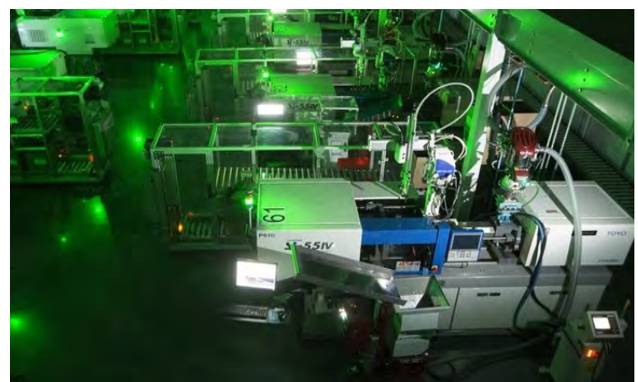
Figuur 22: Voorbeeld van onbemande (cq remote operated) spuitgietfabriek en fabriekscontrolroom
